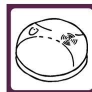
Placez au moins un détecteur de CO par habitation et de préférence 1 à chaque étage. Installez le détecteur à maximum 1,5 mètre du sol et à une distance suffisante d'un appareil qui peut produire du CO.
