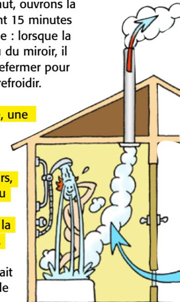
Veillons à ne pas la choisir trop puissante : elle risquerait d'inverser le tirage d'un poêle installé dans la même pièce.
